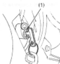
(1) Serratura sterzo (Modello G, IIG, FI)
